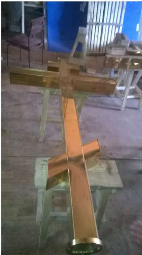
Крест из металла с покрытием нитрид титана
